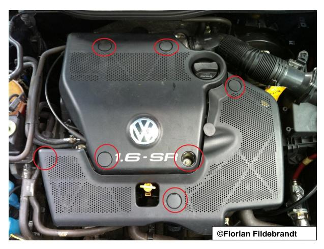
Im Anschluss müssen alle Anbauteile, Schrauben, Muttern und Clipse von der Ansaugbrücke gelöst werden um diese zu demontieren. Das ist nötig da die Zündkerze nahezu unerreichbar darunter sitzen.
